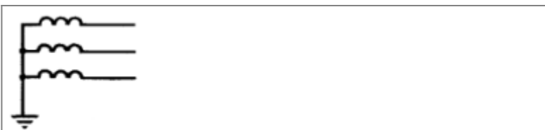
Трёхфазная сеть. Трёхпроводная с заземлённой нейтралью.
