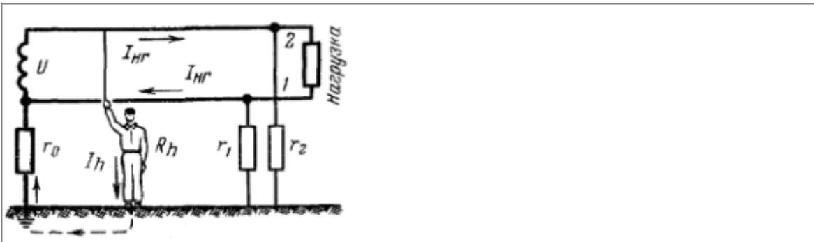
Прикосновение человека к незаземлённому проводнику однофазной двухпроводной сети. Нормальный режим работы сети.
