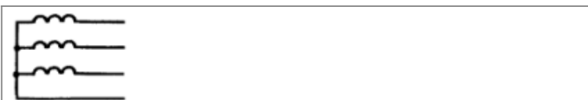
Трёхфазная сеть. Четырёхпроводная с изолированной нейтралью.
