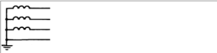
Трёхфазная сеть. Четырёхпроводная с заземлённой нейтралью.
